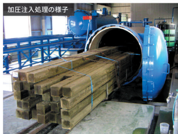
タンクの中に木材を入れ、高い圧力をかけながら、薬剤を木材内部に深く浸透させます
