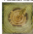
木材の内部まで深く浸透している
