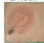
木材の表面のみ浅く浸透している
