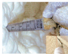
ゲージにて厚み計測
