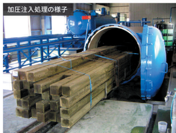
▼加圧注入処理した緑の柱
